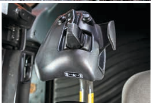
O sistema de direção com joystick opcional garante um controlo excelente.
