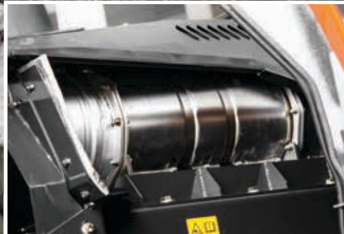
O sistema SCR reduz as emissões e o ruído.
