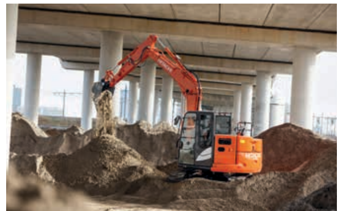
O raio de rotação curto faz da ZX85USB-6 a máquina ideal para trabalhar em espaços reduzidos.
